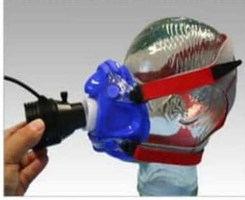
شكل (٧) تركيب مجس التدفق التوربيني
